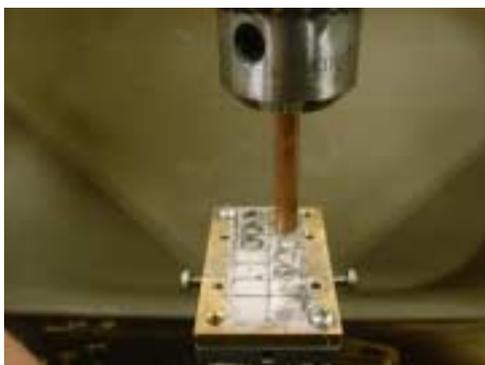
図 14 放電加工機で打ち抜く様子
