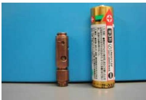
図 2 SQUID 磁束計対応型 DAC
