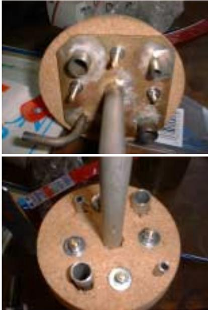
4つの穴に真鍮棒のねじを通し、コルクと真鍮板をねじでつなげる。歯止めを2枚重ね、ナットで両側から閉める。
