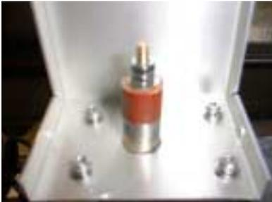
長さ29mmのベークライトは雄ねじを作るためにダイスでねじを切った。この雄ねじは25mmのベークライトとつなげるために作った。また、押しねじを通す穴をボール版で3ヶ所開けた。
